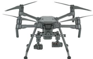
Sensori AGX 710 e ZENMUSE XT montati su DJI MATRICE 210
